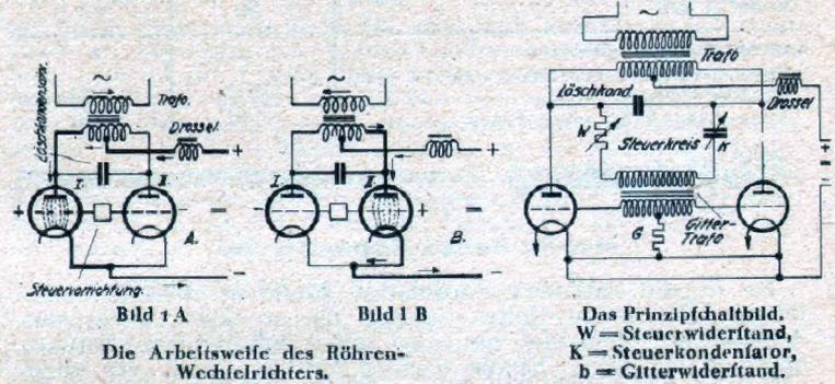
die Steuervorrichtung inzwischen eine negative Spannung erhalten hat. Jetzt fließt der Strom durch die rechte Hälfte der Primärwicklung (Bild 1B) und durch den Stromrichter II zum Gleichstrom-Minuspol. Als Folge dieses Stromflusses wird in der Sekundärspule dementsprechend ein Strom von rechts nach links hervorgerufen. Auch der Kondensator lädt sich erneut auf, diesmal aber in umgekehrter Richtung wie vorher.
