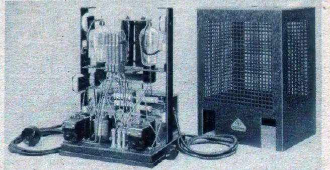
Ein Klein-Wechselrichter von Siemens.
