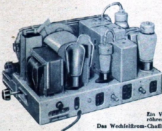
Ein Vertreter der Dreiröhren-Reflex-Superhets. Das Wechselstrom-Chassis des Mende „289“.
